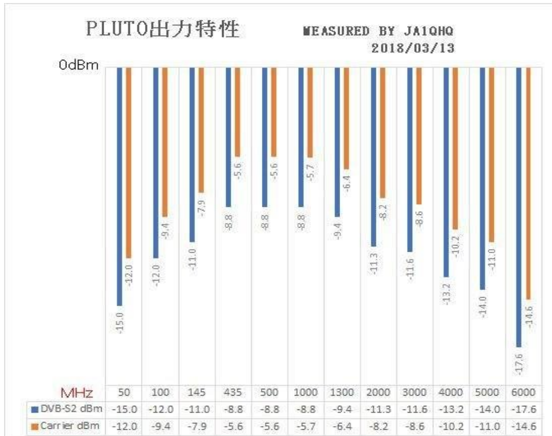
図 18 PlutoSDR の送信出力特性
