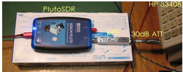
図 11 PlutoSDR 単体の受信感度を測定
