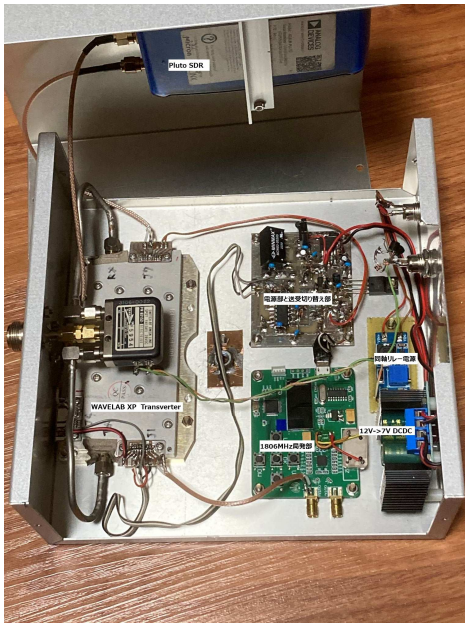
トランスバーター内部写真
